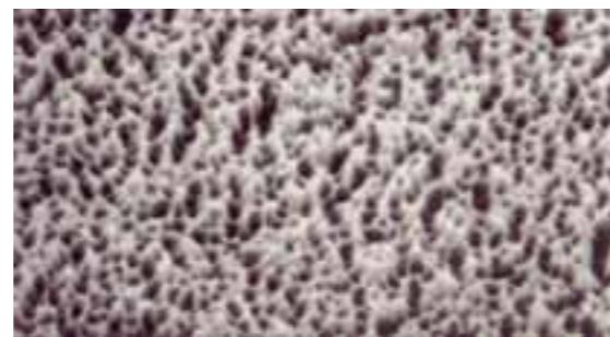
PTFE surface: After plasma treatment PTFE-Oberfläche: Nach der Plasmabehandlung
